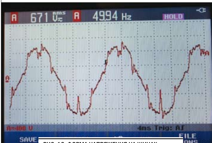
РИС. 12. ФОРМА НАПЯЖЕНИЯ НА ШИНАХ ГЕНЕРАТОРОВ ДО ВКЛЮЧЕНИЯ ФИЛЬТРОВ
