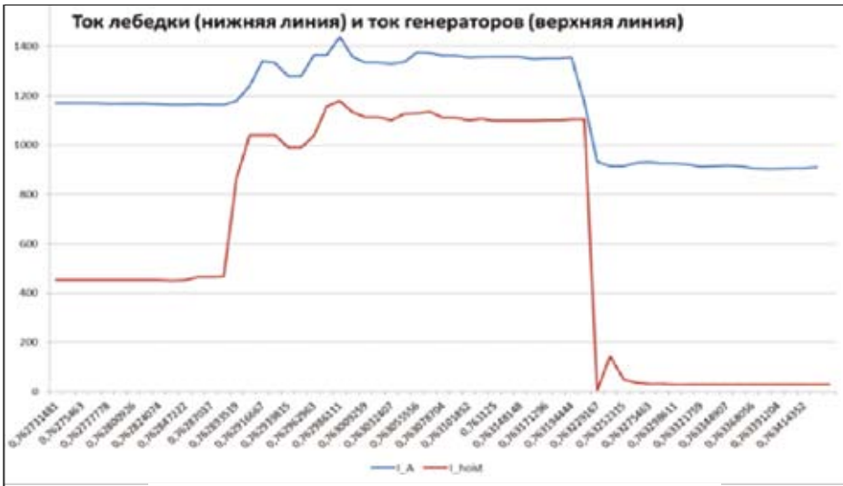
РИС. 10. ИЗМЕНЕНИЯ ТОКОВ ПРИ ВКЛЮЧЕНИИ ПРИВОДОВ ЛЕБЕДКИ
