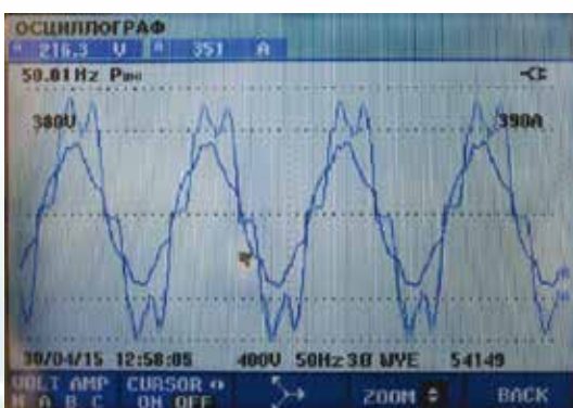
Ток и напряжение в фазе. Фильтр ОТКЛЮЧЕН
