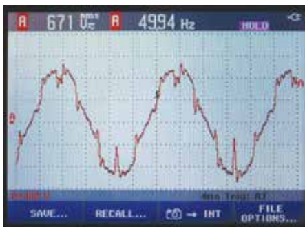
До включения фильтров THDu = 13%
